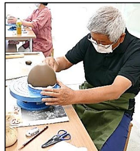
石膏型にしっかり粘土を合わせ、引き締める作業。
